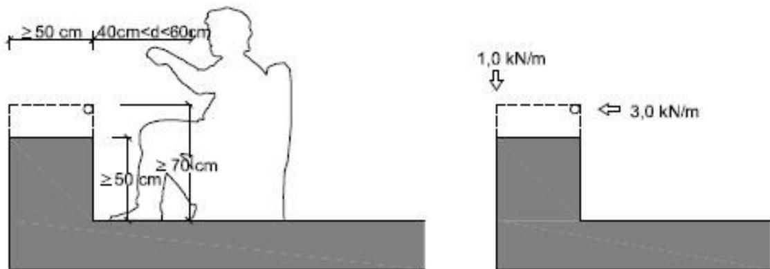
Figura 3.3 Barrera de protección frente a asientos fijos.
